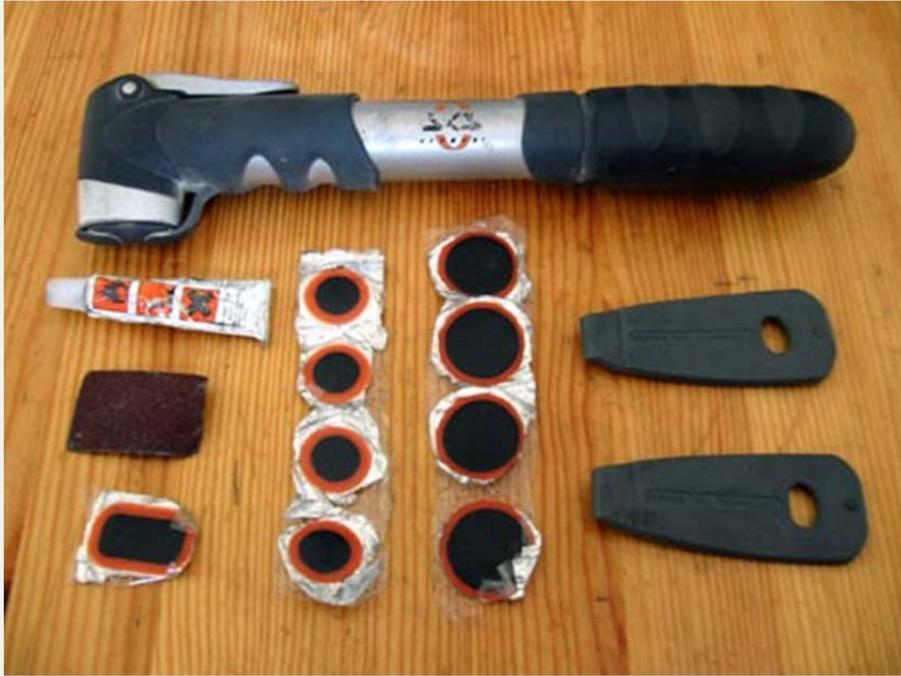
Material para arreglar un pinchazo: parches de diversos tamaños, pegamento, lija, desmontables y bomba.
