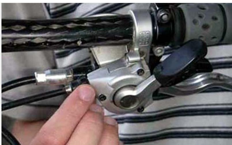
El tensor del desviador delantero está situado en la maneta de cambio
