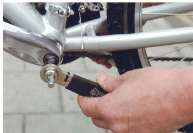
3. Use la herramienta específica para extraer y reemplazar el eje de pedalier.
