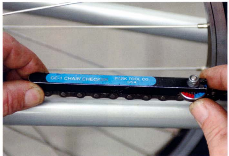
3. Existen herramientas especiales que permiten comprobar el desgaste de la cadena.
