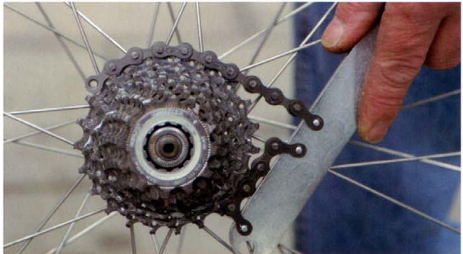
1. Para efectuar usted mismo las reparaciones necesitará un extractor de coronas.
