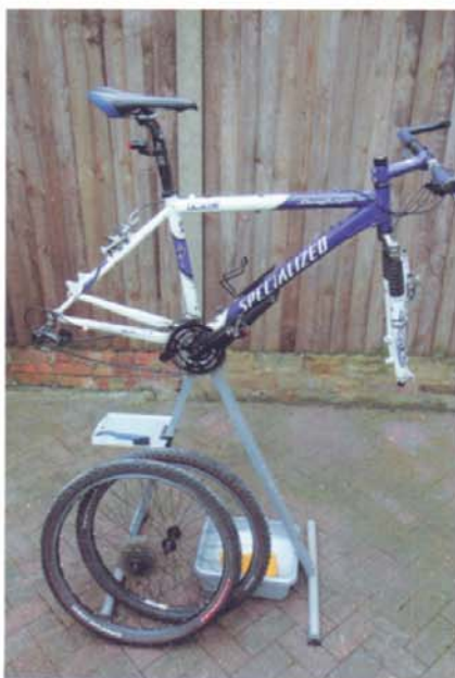
1. Antes de limpiar la bicicleta, colóquela sobre un soporte y saque las ruedas.
