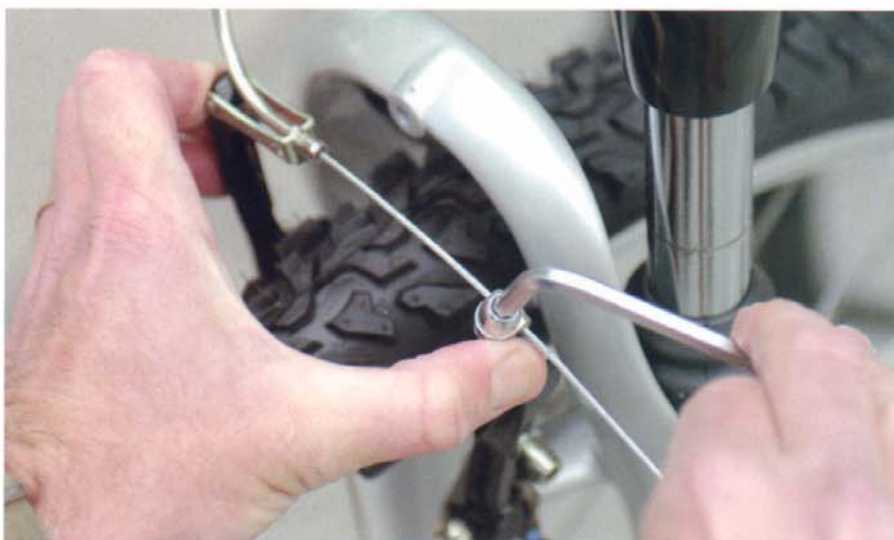
3. Tire del cable para tensarlo y apriete bien el tornillo escañacables.
