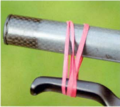
6. Fije la palanca de freno al manillar con una goma elástica.
