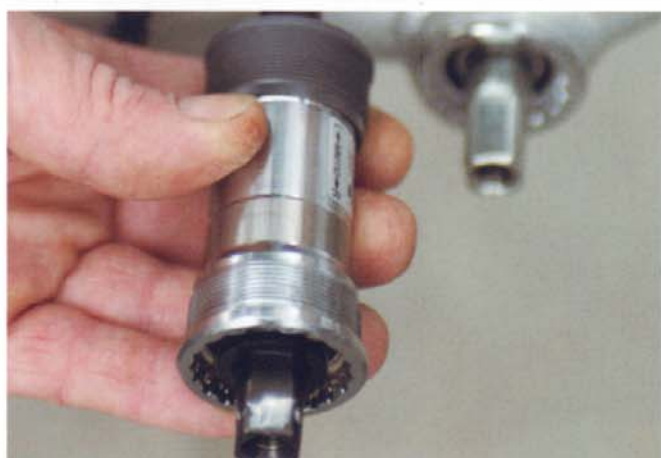
2. Ajuste la parte interior de la llave para extraer el eje.
