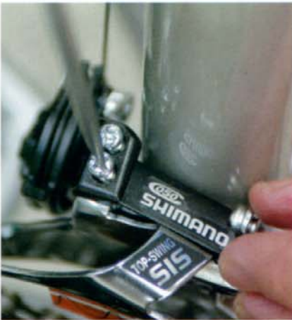
1. Ajuste el desviador apretando o aflojando el tornillo marcado con una L.
