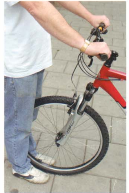
4. Sujete la rueda y gire el manillar para comprobar si la horquilla está apretada.
