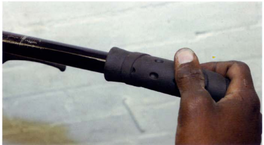
2. Antes de colocar el puño nuevo, rocíe el manillar con laca de cabello para lubricarlo.
