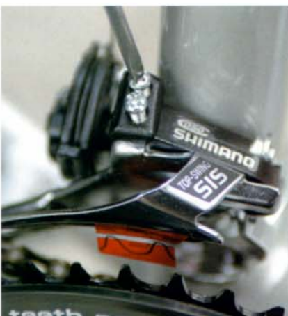
3. Ajuste la placa exterior del desviador por medio del tornillo marcado con una H.
