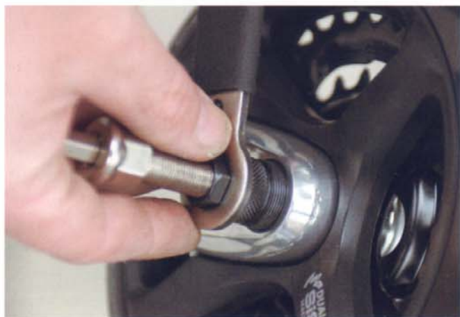
1. Ajuste la parte externa de la herramienta al roscado de la biela con una llave específica.
