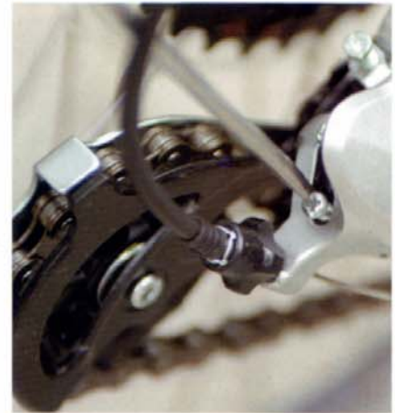
4. Mueva el desviador para colocar la rueda guía debajo del piñón pequeño.
