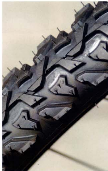
3. Compruebe las cubiertas en busca de marcas de desgaste, cortes y pellizcos.
