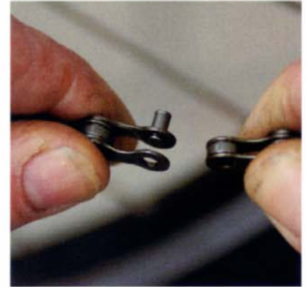
1. Corte los eslabones del extremo de la cadena que no terminan en un perno.
