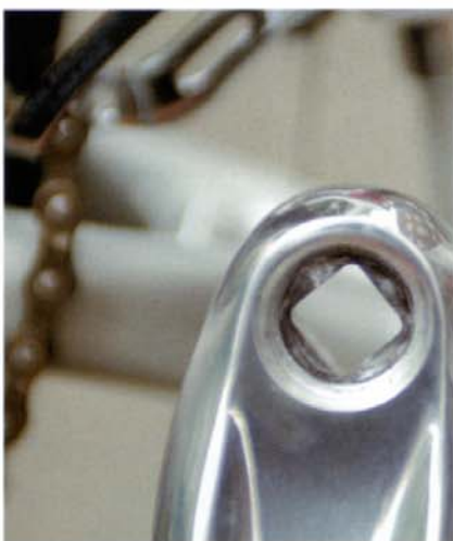
1. Los tornillos de fijación cuadrados se aflojan con una herramienta especial.
