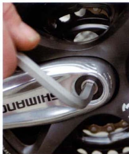
2. Para desmontar una biela actual sólo se necesita una llave Allen.
