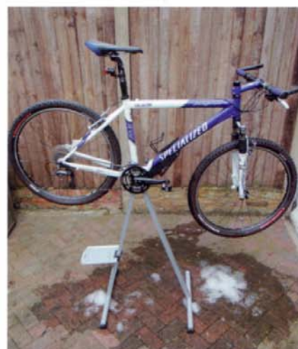
4. En cuanto las ruedas vuelvan a estar en su sitio, enjuague toda la bicicleta con agua limpia y séquela bien.
