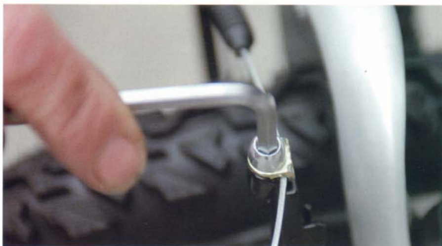
1. Antes de retirar el cable, fíjese en la posición del tornillo escañacables.
