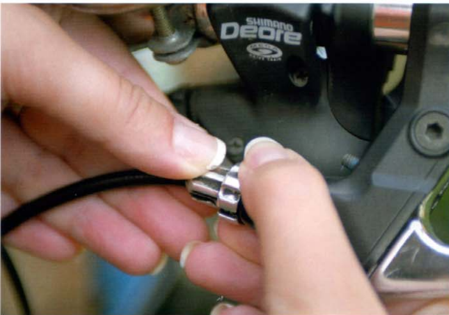
4. Gire el tensor en sentido contrario a las agujas del reloj para tensar el cable de freno.
