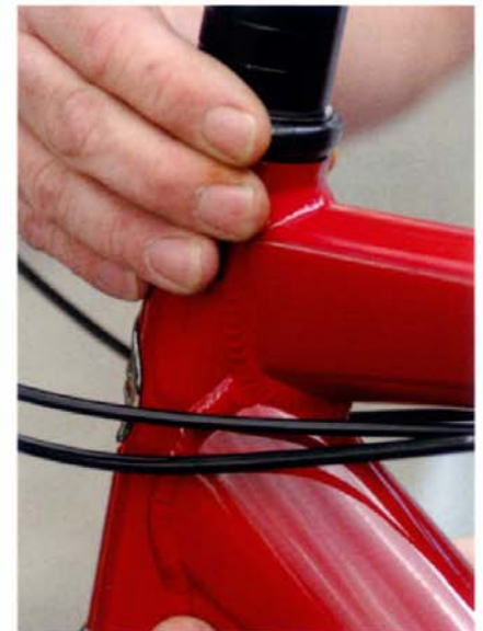
5. Asegúrese de que no haya fisuras en el tubo de dirección.
