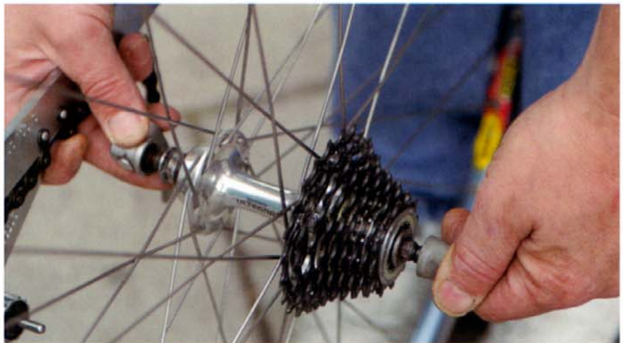
2. Sujete la rueda entre sus rodillas y afloje el casete de coronas.
