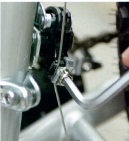
2. Inserte el cable, ténselo y compruebe que siga el mismo recorrido que el original.
