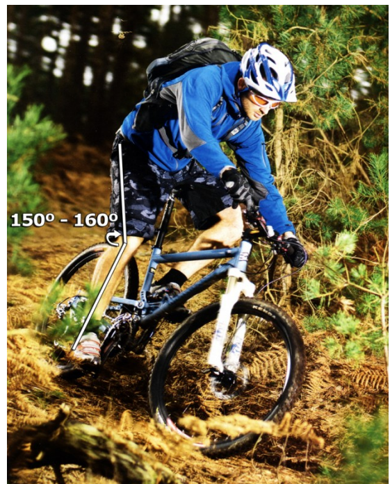
Punto más bajo del recorrido del pedal. Foto: MBR Mountain Bike Rider. 2007, núm. March 2007, p. 96.
