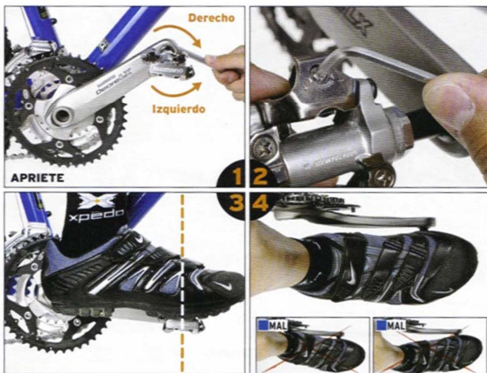
**1** Si cambias los pedales por primera vez puede que te topes con el problema de las roscas. El derecho (R) aprieta en sentido normal, es decir, en sentido de las agujas del reloj, pero el izquierdo (L) tiene rosca inversa. Según la marca necesitarás una llave plana de 15 mm. o una Allen de 8 mm.
